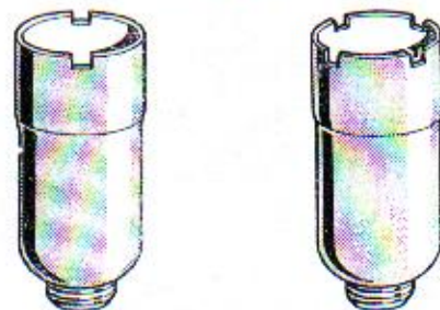
Fraise pour exécuter la gorge d'extraction dans le siège de soupape.
