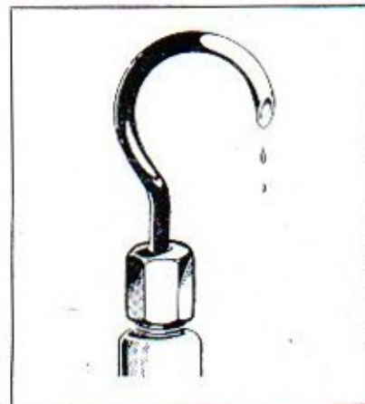
Tube coudé en forme de col de cygne pour la recherche du début d'injection sur la pompe.
