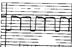
Défaut de phase et diode négative en court-circuit
